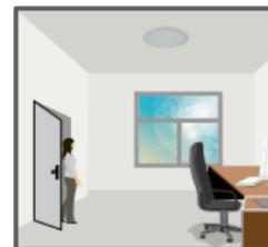
Si se active el sensor e luz, y hay suficiente luz natural el equipo se mantiene apagado.
